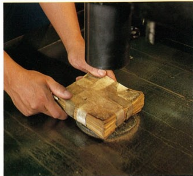
【7】これを石場にのせて楯、又はピストンで圧延する。紙一杯に延びたものを「荒金」という。この工程を二回繰返す。
