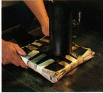
【9】更に又寸法の大きい澄打紙「大重」に一枚毎にはさんで八百枚位を同じ要領で圧延する。この段階で約 \frac{3}{10} ミリとなる。
