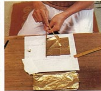
【11】次にこの「打上澄」を三十枚重ねて折り目からたち包丁で切り(A-C)三ツ折にして澄箔に入れ(これを「仕上り澄」という)て、箔屋に届け、ここで箔打工程に入るわけである。
