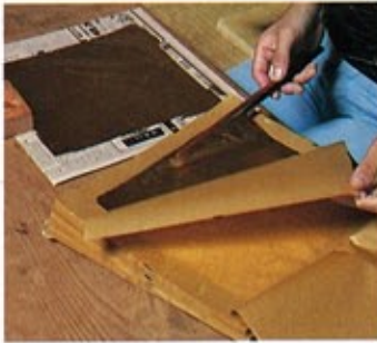
【10】次に「大重」より更に寸法の大きい澄打紙「上り」に移し入れ、七五〇枚位重ねて圧延し、この段階を終ったものを「打上澄」という。
