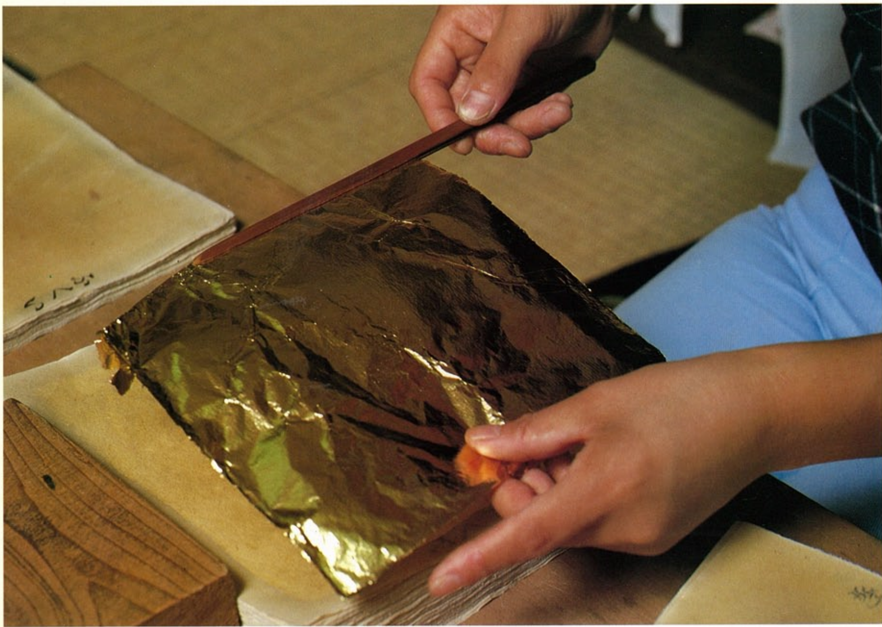
【9】更に又寸法の大きい澄打紙「大重」に一枚毎にはさんで八百枚位を同じ要領で圧延する。この段階で約 \frac{3}{10} ミリとなる。
